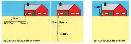
FIGURE 1.1 TYPICAL HEAT PUMP COLLECTOR CONFIGURATIONS.
