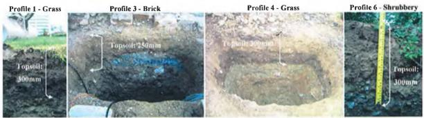
FIGURE 3.19 HORIZONTAL COLLECTOR GROUND COMPOSITION.
