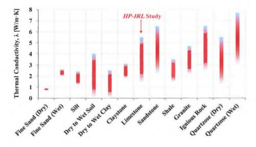
FIGURE 2.13 THERMAL CONDUCTIVITY OF TYPICAL SOIL AND ROCK TYPES (IGSHPA *et al.*, 1989).
