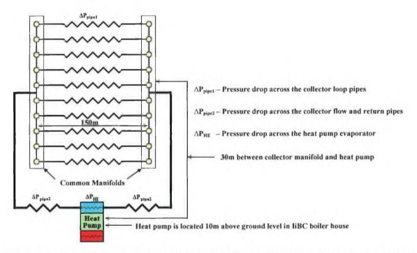
FIGURE 3.22 PLAN VIEW SCHEMATIC REPRESENTATION OF THE HEAT PUMP-TO-COLLECTOR PIPING CIRCUIT.
