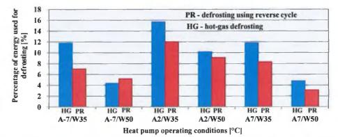
**FIGURE 2.18** PERCENTAGE OF TOTAL HEAT PUMP ENERGY CONSUMPTION THAT IS PARASITIC FOR DEFROSTING PURPOSES (ZOGG, 2003).
