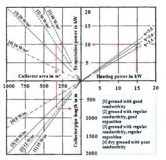
FIGURE 2.6 NOMOGRAM FOR SIZING HORIZONTAL GROUND LOOPS (SIA-DOCUMENTATION D0136, 1996).
