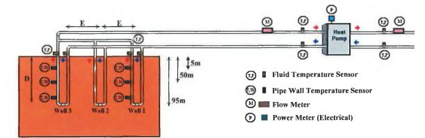
**FIGURE 3.24** PIPING AND INSTRUMENTATION SCHEMATIC FOR THE *HP-IRL'S* VERTICAL COLLECTOR GROUND SOURCE HEAT PUMP.
