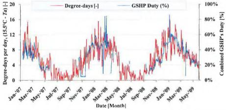
FIGURE 3.6 IIBC DAILY AVERAGED HEAT DEMAND VERSUS HEAT PUMP DUTY BETWEEN 2007 AND 2009.
