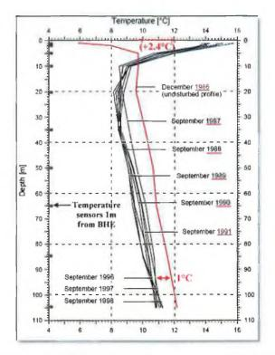
FIGURE 2.11 TEMPERATURE DRAWDOWN OF A VERTICAL COLLECTOR MONITORED OVER A FIVE YEARS OPERATION IN SWITZERLAND (EUGSTER AND RYBACH, 2000).
