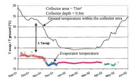
FIGURE 2.4 HEAT PUMP EVAPORATOR AND THE GROUND TEMPERATURE WITHIN THE HORIZONTAL COLLECTOR (DUMONT AND FRÊRE, 2005).
