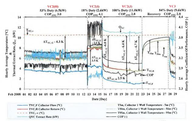
FIGURE 6.17 THERMAL DRAWDOWN AND RECOVERY OF THE GROUND SURROUNDING THE GSHP<sub>VC</sub> VERSUS HEAT PUMP PERFORMANCE DURING VC 2 AND VC3.
