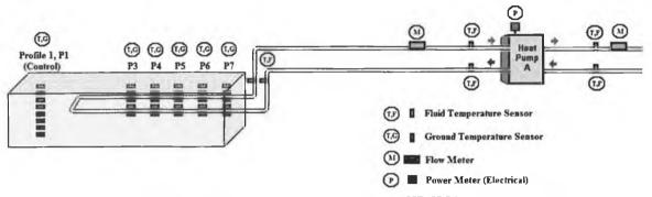
**FIGURE 3.14** PIPING AND INSTRUMENTATION SCHEMATIC FOR *HP-IRL*'S HORIZONTAL COLLECTOR GROUND SOURCE HEAT PUMP.
