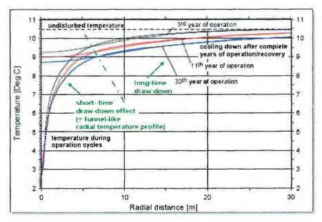
FIGURE 2.12 POTENTIAL TEMPERATURE DRAWDOWN AT VARIOUS RADIAL DISTANCES FROM THE VERTICAL COLLECTOR OVER THIRTY YEARS OF OPERATION IN SWITZERLAND (EUGSTER AND RYBACH, 2000).
