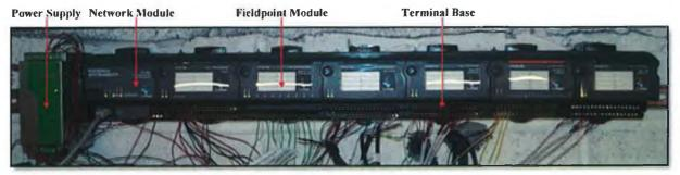
FIGURE 3.27 HP-IRL DATA ACQUISITION SYSTEM.
