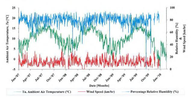
**FIGURE 3.12** WEATHER VARIABLES THAT IMPACT ON ASHP OPERATION RECORDED BY THE *HP-IRL* WEATHER STATION (2007-2010).
